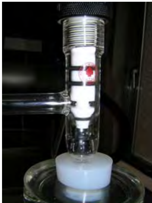
図 6: デシケータバルブ。下側の O リングが壁に密着していないように、ゆるめます。横の目盛りで見て、2~3mm で十分だと思います。
